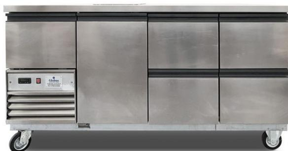
Banco frigo inox 170x70xh93 cm. Alimentazione elettrica; allaccio tipo SPINA SCHUKO; tensione 220 V; potenza 0,4 kW; peso kg 100. Dotato di ruote e composto da 5 cassettoni 53x30xh22 cm + 1 anta armadio 58x33xh60 cm. Regolazione temperatura solo positiva da +2° C. Display digitale.
