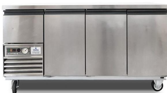
Banco refrigeratore inox 170x70xh92 cm. Alimentazione elettrica; allaccio tipo SPINA DOMESTICA; tensione 220 V; potenza 0,4 kW; peso kg 100. Dotato di ruote e composto da 3 ante armadio freezer 33xh57 cm + 1 cassetto frigo 30xh23 cm. Regolazione temperatura freezer da -15° a 0° C; regolazione temperatura frigo da 0° a + 5° C.
