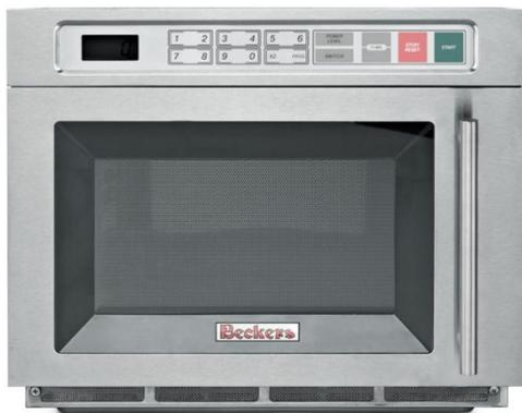
Forno a microonde elettrico con doppio magnetron. Allaccio tipo SPINA SCHUKO; tensione 220 V; potenza da 0,9kW a 1,8 kW; 3 livelli di potenza alto - medio - defrost (scongelamento). Dim. esterne 49x64xh40 cm; peso kg 35; capacità 30 lt; dim. interne 37x37xh19 cm. Dotato di display digitale e completo di 2 piatti fissi in ceramica.
