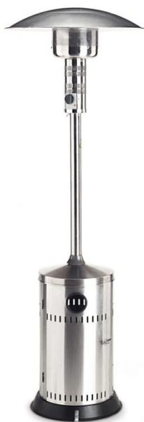
Fungo riscaldante in acciaio inox, accensione piezoelettrica, valvola anticaduta, completo di tubo e regolatore di pressione, ideale per riscaldare tavolo 8/10 persone, altezza 2,2 mt., cappello Ø 80 cm. Potenza termica 5-11 Kw - Area 20/25 mq / Consumo medio: min/max 450 g/hr - 790 g/hr (Bombola non in dotazione - compatibile con bombola da 10 o 15 kg).
