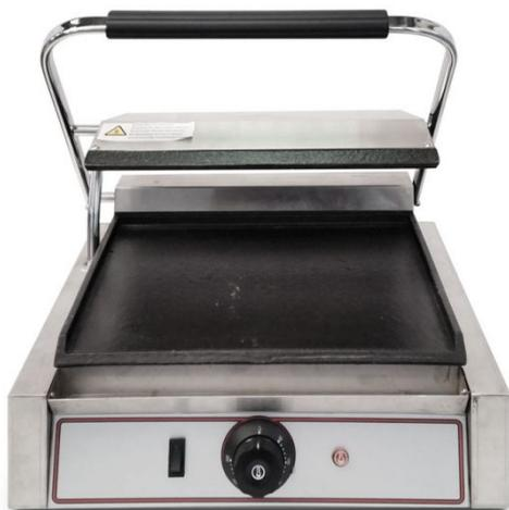
Piastra grill liscia elettrica 43x31xh22 cm. Liscia sotto e sopra, dotata di piastre in ghisa e telaio in acciaio inox. Piano cottura dim. 36x28 cm; temperatura +50°C - +300°C; potenza 2,2 kW; voltaggio 230 V.
