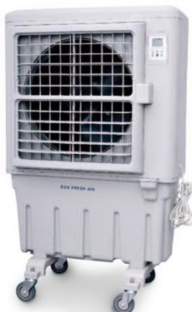
Rinfrescatore evaporativo 6000 m<sup>3</sup>/h, dimensioni 85x47x h128 cm, peso 32 kg; alimentazione 220-240 V; consumo 290 W. Fornisce ventilazione per un totale di area rinfrescata di ca. 150/180 mq. Dotato di serbatoio d'acqua da 60 litri, consumo medio da 4 a 6 lt acqua/ora (possibilità di allaccio a rete idrica). Ventilazione silenziosa 53-58-63 dB; non nebulizza e non distribuisce acqua nell'ambiente.
